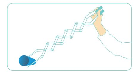
es demasiado largo es difícil de controlar, pero si es demasiado corto tendrá una movilidad y un uso limitados. Se pueden emplear distintos materiales en diferentes partes del brazo para mejorarlo. El mejor material para la estructura principal sería uno robusto y ligero.
