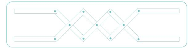
**6** Une cinta adhesiva o tapones de botella a los dos extremos para sujetar objetos. Esto mejorará el agarre del brazo robótico. Con esto ya deberías tener un brazo robótico similar al de esta imagen:
