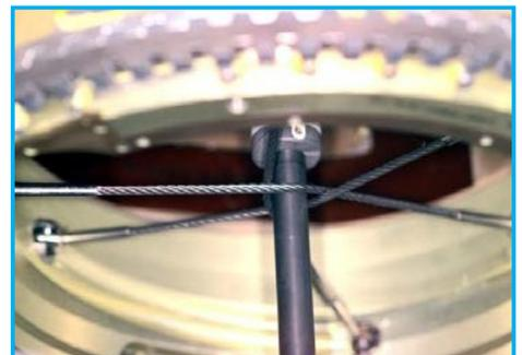
*Des collets fermés autour d'un axe de fixation du grappin.*
