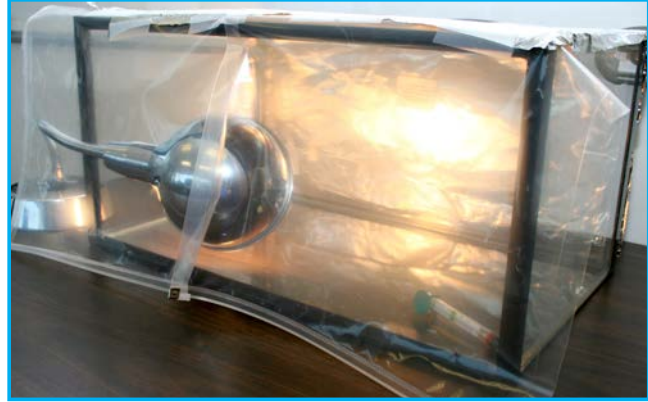
Imagen 2: Incubadora hecha de un acuario de 35 litros con cubierta de plástico cerrada.
